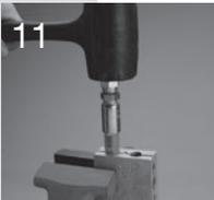
Avec un marteau en caoutchouc, taper l'embout légèrement sur le tuyau, jusqu'à ce que le bord inférieur du manchon concorde avec le repère de la profondeur d'insertion.
