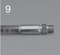
Introduire le tuyau jusqu'au repère de la profondeur d'insertion dans l'embout.
