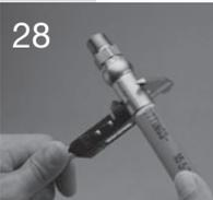
Mesurer à nouveau le diamètre de sertissage sur chaque embout en haut, au centre et en bas sur le manchon. Mesurer la circonférence du manchon à au moins trois endroits. Contrôler si le diamètre de sertissage se trouve au sein des tolérances. (Pour le diamètre de sertissage correct, voir le tableau Diamètres de sertissage et sélection de l'outillage dans ce chapitre du catalogue).
