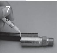
Marquer l'extrémité du tuyau avec la profondeur d'insertion correcte.
