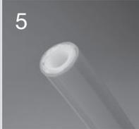
Contrôler visuellement la perpendicularité des deux extrémités. Retirer les bavures éventuelles sur le tube intérieur avec un couteau tranchant.
