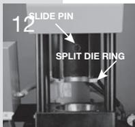
Faire monter complètement le poussoir vers le haut et insérer la moitié arrière de l'anneau de réglage divisé dans la partie arrière du poussoir. Bloquer l'anneau en introduisant la goupille de verrouillage.
