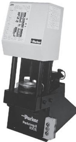
Pour le sertissage des tuyaux Parker avec renforcement en tresse textile ou en fil métallique ainsi qu'avec des nappes en fil d'acier jusqu'à DN 50. Avec groupe hydraulique et cadre de base, mais sans jeux de mors.
