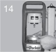
Appliquer l'anneau de réglage qui convient sur le jeu de mors. Pour la sélection de l'anneau de réglage, voir le tableau de sélection Outils de sertissage dans le présent manuel.
