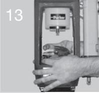
Appliquer une fine couche de graisse lubrifiante à base de disulfure de molybdène sur le réceptacle de mâchoire.
