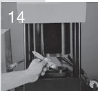
Appliquer une fine couche de graisse lubrifiante à base de disulfure de molybdène sur le côté intérieur de l'élément adaptateur.
