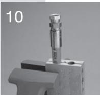
Appliquer l'embout de la manière suivante en tapotant sur le tuyau : Utilisez les mâchoires d'étau VBS ou VBL de Parker et y introduire le tuyau avec l'embout dans l'ouverture correcte. Insérer ensuite les mâchoires avec le tuyau et l'embout dans un étau fixé sur un établi.
