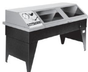
Ce banc d'essai d'atelier convient pour le contrôle de pression statique des tuyaux assemblés avec une pression de contrôle de 12 à 145 MPa. Presque tous les embouts standard peuvent être contrôlés.
