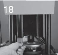
Insérer la moitié avant de l'anneau de réglage et aligner la goupille dans la moitié arrière avec le trou dans la moitié avant.
