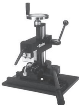
L'appareil de marquage **polyflex** TH4-4 sert au marquage permanent des tuyaux assemblés ou de la douille des embouts. La version standard comprend l'appareil de table avec plaque de base, un volant manuel réglable en hauteur, un porte-caractères à fixer ainsi qu'une cassette à caractères avec des caractères en acier trempé.
