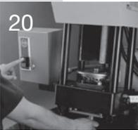
Pour allumer la pompe, actionner l'interrupteur respectif.
