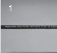
Contrôler si les indications relatives au type et au diamètre nominal sur le marquage du tuyau sont conformes à la mission de travail.
