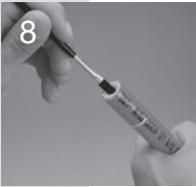
Lubrifier légèrement la face intérieure de l'extrémité du tuyau avec une huile lubrifiante SAE 20.
