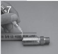
Marquer l'extrémité du tuyau avec la profondeur d'insertion correcte. (Profondeur d'insertion = Dimension « A » moins « B » Selon les tableaux des embouts aux chapitres B à E)
