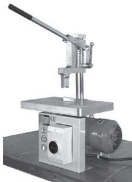
La tronçonneuse **polyflex** ST250 est destinée à couper les tuyaux avec renforcement en métal ou en fibres textiles (jusqu'à 6 nappes) jusqu'au DN 25. Cette tronçonneuse convient pour la fabrication de petites séries, d'assemblages de tuyaux individuels et pour les ateliers de réparation.
