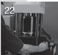
Sertir l'embout avec le tuyau jusqu'à ce que l'anneau de réglage soit en applique sur la plaque de base.
