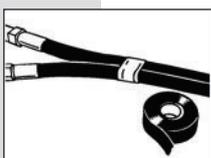
Selon l'exigence d'installation, dans la zone terminale des tuyaux séparés, maintenir ensemble les extrémités de tuyaux mobiles avec du ruban en nylon ou adhésif, afin de protéger le revêtement des tuyaux contre un déchirement.
