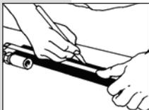
Mesurer et marquer la longueur jusqu'à laquelle les tuyaux doivent être séparés.
