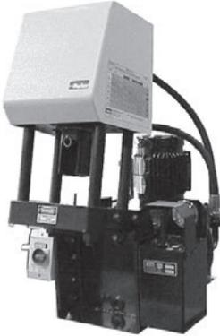
Pour le sertissage des tuyaux Parker avec renforcement en tresse textile ou en fil d'acier ainsi qu'avec des nappes en fil d'acier jusqu'à DN 32. Avec groupe hydraulique et cadre de base, mais sans jeux de mors.
