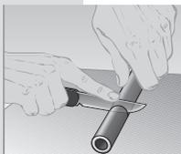
Découper le tuyau à la verticale avec un couteau tranchant. Si nécessaire, humecter l'extrémité de l'embout avec de l'eau ou une solution d'eau savonneuse (5 % de savon liquide + 95 % d'eau) pour faciliter le montage.
