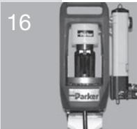
Introduire le tuyau avec l'embout par le bas dans le jeu de mors.
