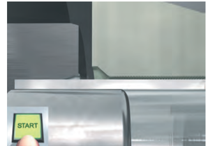
Au lancement du processus, le tube est bridé et le poinçon est inséré dans le tube
