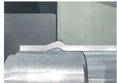
Le diamètre intérieur est légèrement déformé, mais ne génère aucune perte de débit
