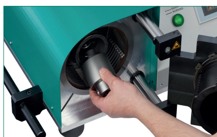
Einsetzen des Formstutzens mit Bajonetverschluss – ohne jegliches Werkzeug
