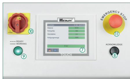
Bedienbereich der Rohrformmaschine
