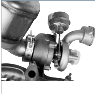
Automobil: Verbindung Turbolader – Katalysator
