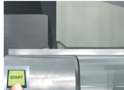
Nach Starten des Prozesses wird das Rohr gespannt und der Dorn wird in das Rohrende getrieben
