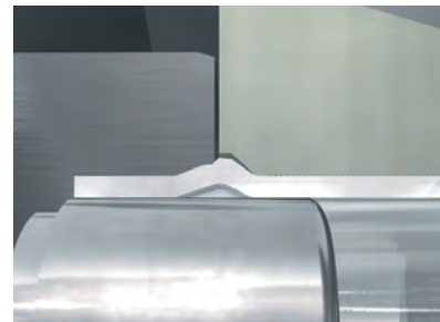
Der Innendurchmesser wird ebenfalls leicht verformt, dabei entstehen keine schroffen Übergänge
